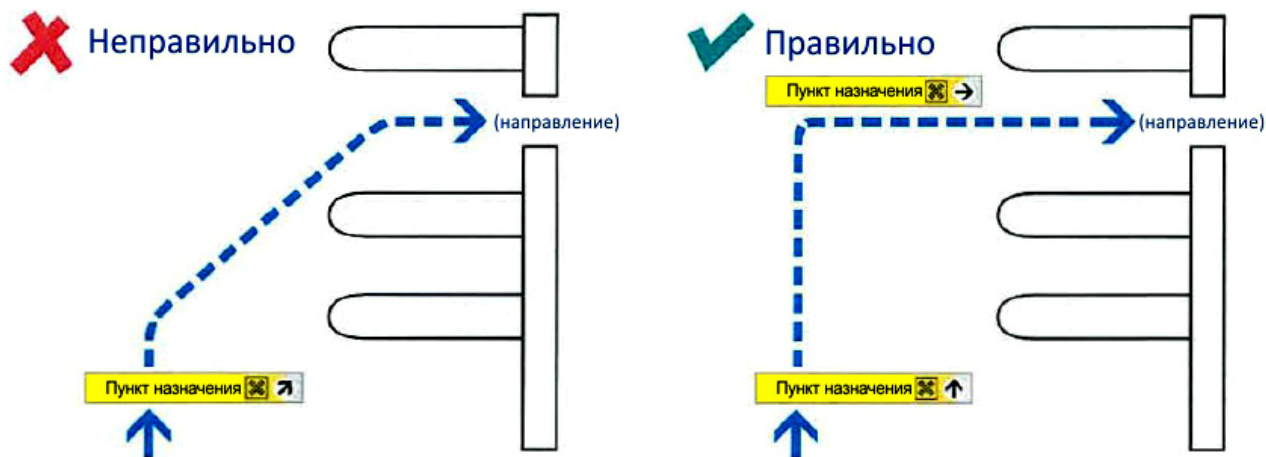
Рис. 14. В этой ситуации вместо одного указателя с косой стрелкой следует использовать два указателя [2]
